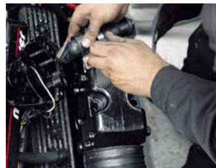
9 De slangar som tagits bort sätts åter på plats på avgasknät.
