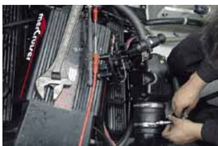
13 Slangklämmorna dras åt runt avgasknäts mask.
