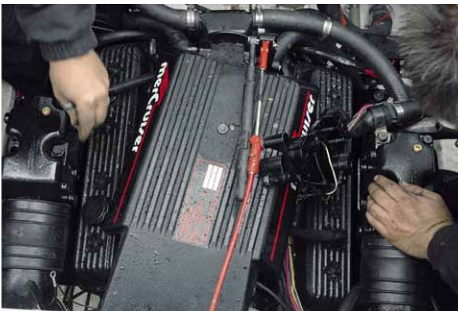
11 V8-motor sedd uppifrån, avgasknät och därunder avgaslimpor på varsin sida av motorblocket.
