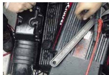
10 Avgasknät skruvas fast.
